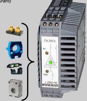
La famille des convertisseurs de mesure CAL35CA permet de transformer des tensions ou courants alternatifs en un courant 0 ... 4 ... 20 mA ou une tension 0 ... 10 V proportionnels à la grandeur d'entrée.
