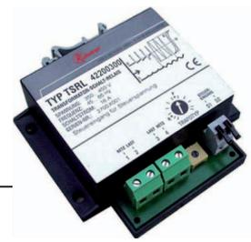
Das Transformator-Schalt-Relais TSRL dient zum sanften Schalten von Einphasentransformatoren. Das TSRL wird einfach zwischen Netzschalter und Transformator geschaltet. Es kann auch als Netzschalter benutzt werden, wenn es über den Steuereingang betätigt wird. In dieser Applikation ist keine Potentialtrennung vorhanden.
