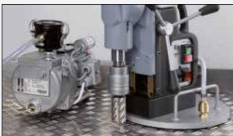
ZAV 300 Vakuumspannvorrichtung für Riffel- und Kreuzbleche
