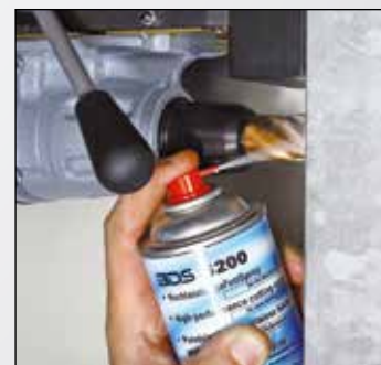
Schritt 2: Während des Bohrens Hochleistungs-fettspray auf die Bohrspitze und in die Bohrung sprühen.
