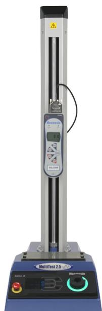
◀ **MultiTest 2.5-dV** für Zug- und Kompressions-Anwendungen bis 2,5 kN; die ideale Wahl für viele verschiedene Routinetests.
