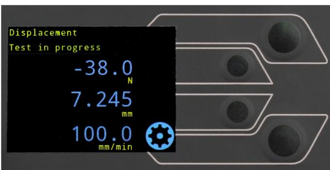
◀ Echtzeit-Daten während des Tests, z.B. Status und Zyklusanzahl, plus Höchstwert- & Probenbruch-Erfassung durch AFG oder volle Daten- Erfassung durch VectorPro™ Lite
