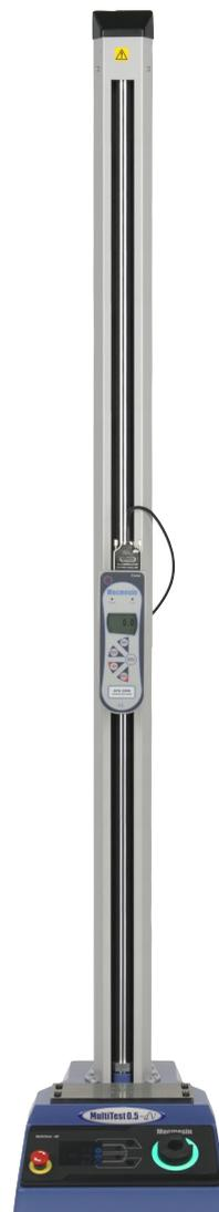
◀ **MultiTest 0.5-dV** für Anwendungen bis 500 N. Durch eine erweiterte Säulenhöhe von 1710 mm (67.3"), ist er ideal für Dehnungstests an hoch- elastischen Werkstoffen wie Gummi.
