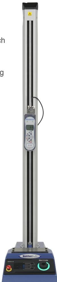
◀ **MultiTest 1-dV** für Zug- und Kompressions-Anwendungen bis 1 kN. Die große Säulenhöhe von 1510 mm (59.4") macht den MultiTest 1-dV eine optimale Wahl für Tests an moderat elastischen Werkstoffen und Produkten.
