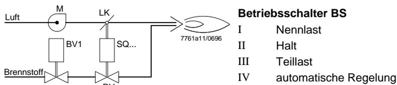
Bei Brennern, die für eine stetige Verstellung der Brennerleistung ausgelegt sind (modulierende Brenner), gehören zur Brennereinrichtung noch die Apparate des Temperaturregelkreises bzw. Druckregelkreises, z.B.
